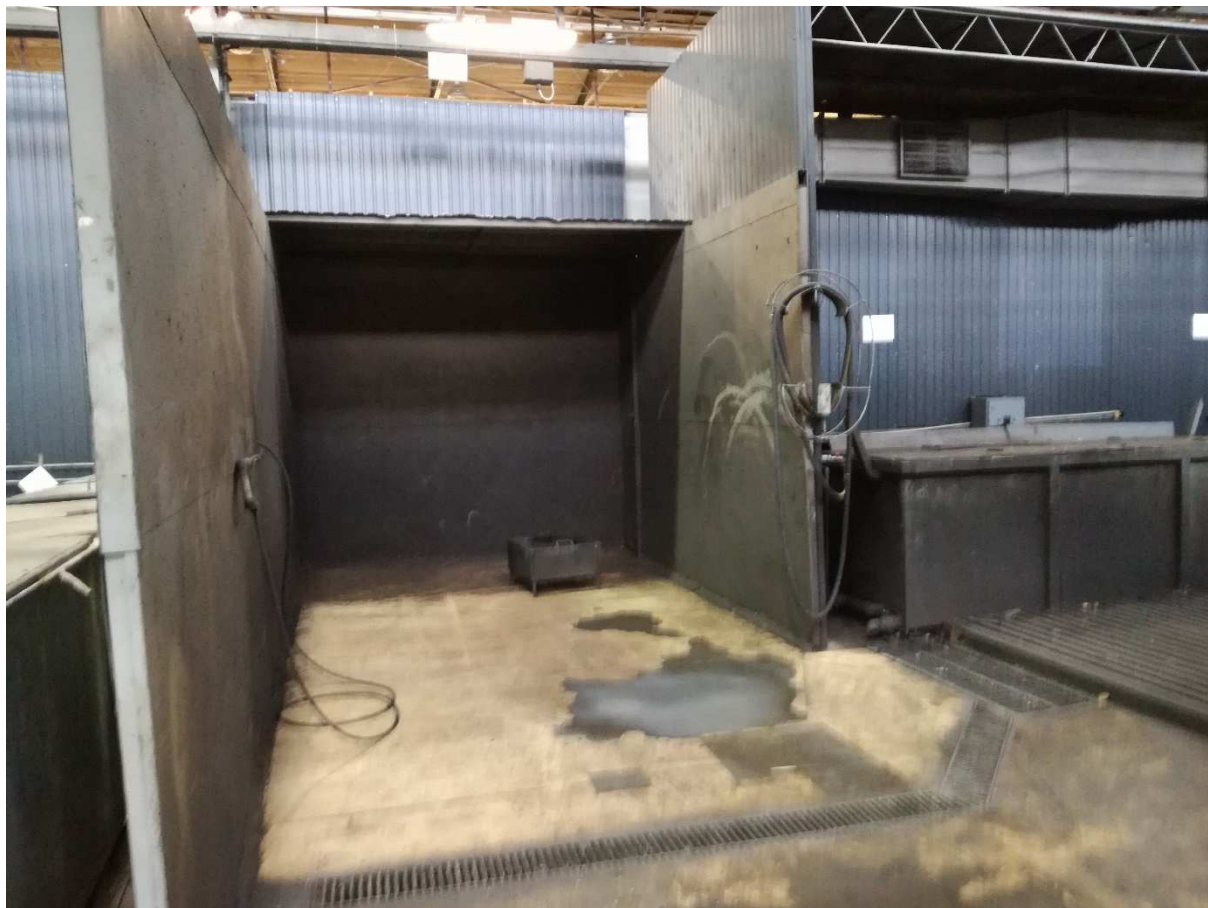
Rysunek 3. Stanowisko do płukania natryskowego myjką wysokociśnieniową.
